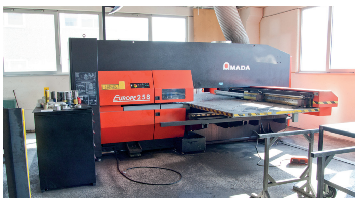
CNC prebijanje pločevine
