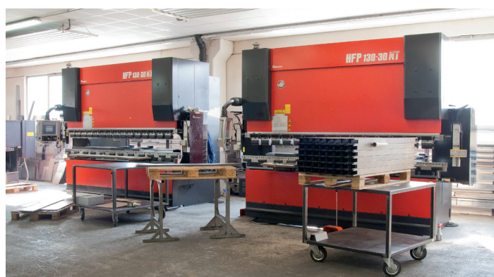
CNC krivljenje pločevine
