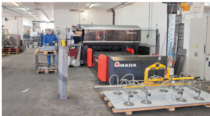
Laserski razrez pločevine
